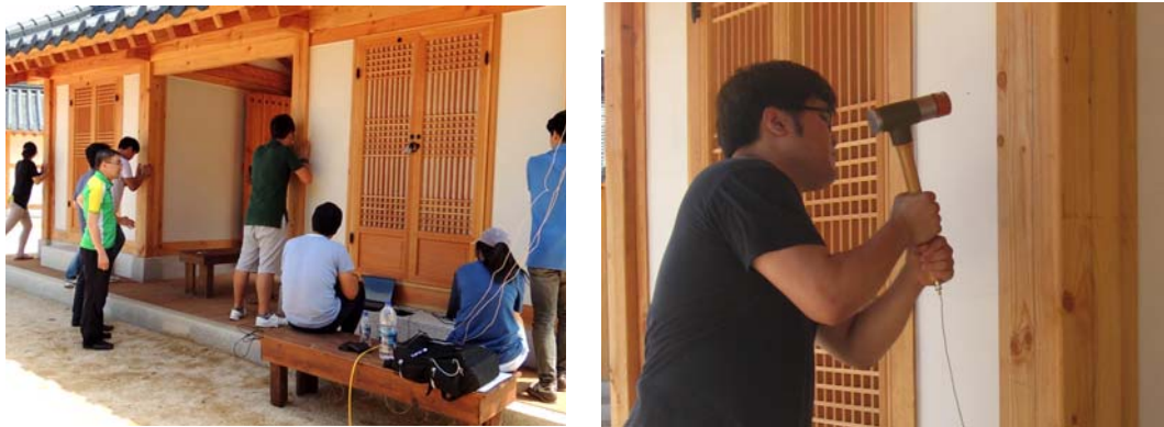
그림 3. 부위별 성능 테스트 동의 인력가진실험(좌) 및 충격하중실험(우)
