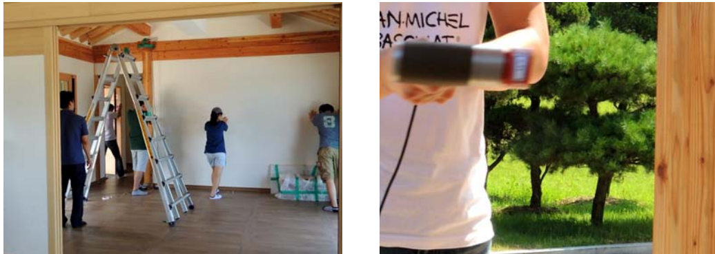
그림 6. 시공 및 성능 테스트동의 인력가진(좌) 및 충격하중실험(우)
