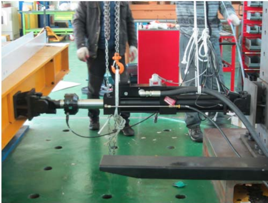
그림 77. 슬라이딩 테이블에 진동 가력기 설치
