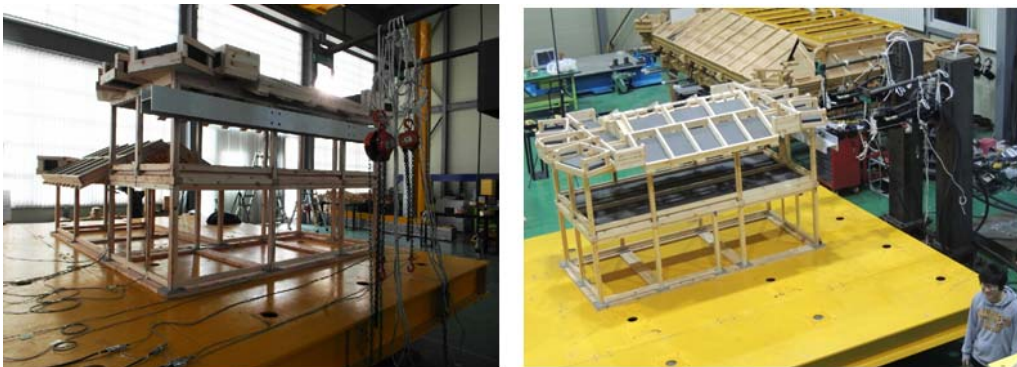
그림 57. 가력프레임 설치 및 가력 모습
