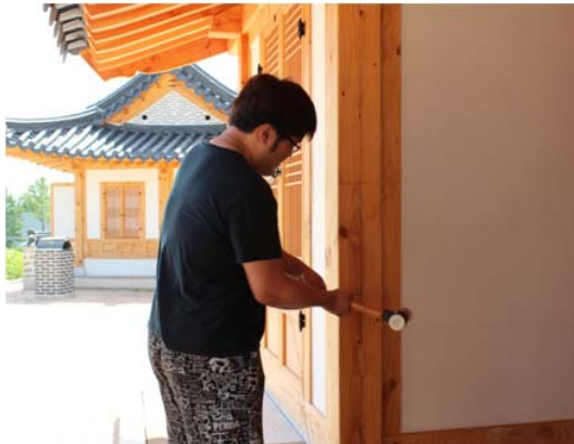
그림 10. 부위별 성능테스트동 충격하중실험
