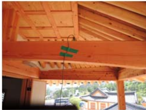
그림 17. 2층 누마루 층랑에 X방향 계측기설치
