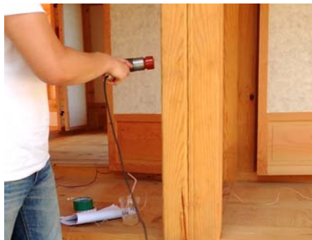
그림 9. 전통한옥 성능 테스트동 충격하중실험
